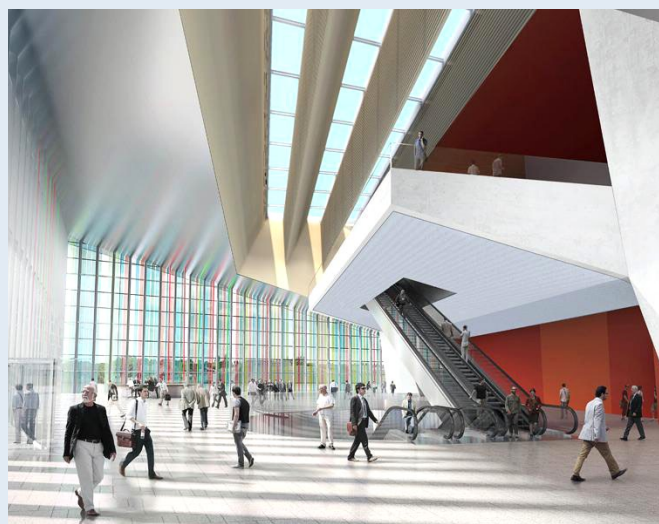
Die Fensterflächen des geplanten Swiss Tech Convention Center mit den integrierten Graezel-Zellen.
