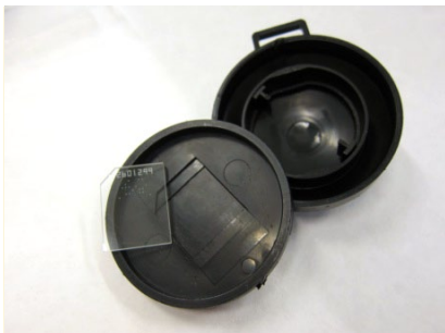
Bild 1: Detektor für die Passiv-Messung von Radon
