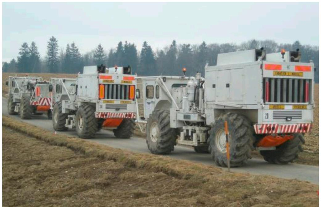
Fahrzeuge für reflexionsseismische Messungen. Quelle: SwissTerraPower
