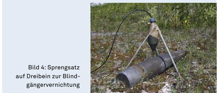
Bild 4: Sprengsatz auf Dreibein zur Blindgängervernichtung
