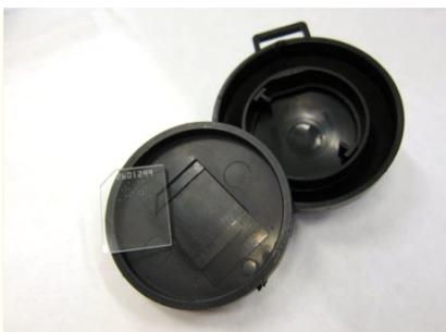
Bild 1: Detektor für die Passiv-Messung von Radon
