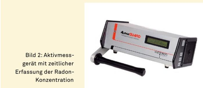
Bild 2: Aktivmessgerät mit zeitlicher Erfassung der Radonkonzentration
