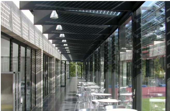
Abbildung 23: Kantonsschule in Stadelhofen (ZH) . Semitransparente Solarmodule schaffen Ambiente und eine gelungene Kombination von Tageslicht, Verschattung gegen Überhitzung und Stromproduktion. Quelle: NET, St. Ursen
