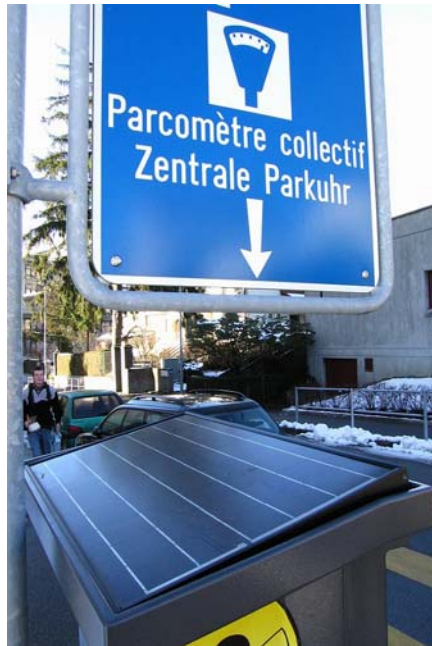
Abbildungen 1 und 2: Parkuhren autonom solar betrieben. Das meist verbreitete Modell in Freiburg i.Ue. mit einer Nahaufnahme des integrierten Solarmoduls. Quelle: M. Gutschner, Freiburg i.Ue.
