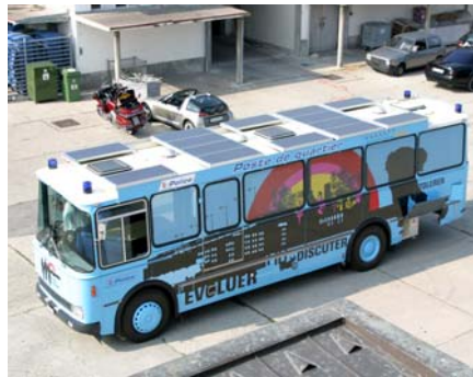
Abbildungen 13 bis 15: Einsatz im rollenden und stehenden Verkehr. Camper in Bamberg (D), mobiler Polizeiposten für die Lausanner Quartiere mit lärm- und emissionsfreier Solarstromversorgung für die Geräte an Bord sowie solares
