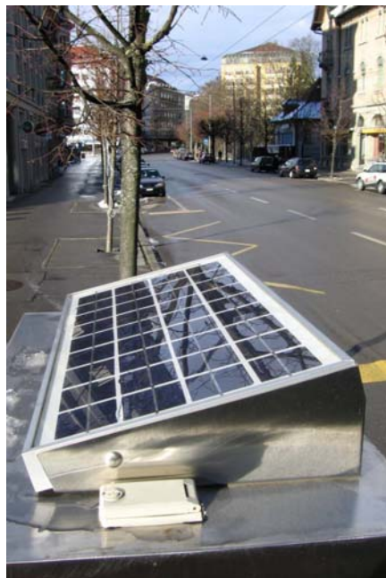
Abbildungen 4 und 5: Fahrkartenautomaten. Die Genfer und Freiburger Verkehrsbetriebe setzen solar betriebene Billettautomaten ein. Die Nahaufnahme des Solarmoduls: Dank der Neigung läuft das Wasser (und der Schnee) gut ab und reinigt gleichzeitig die Oberfläche. Quelle: M. Gutschner, Freiburg i.Ue
