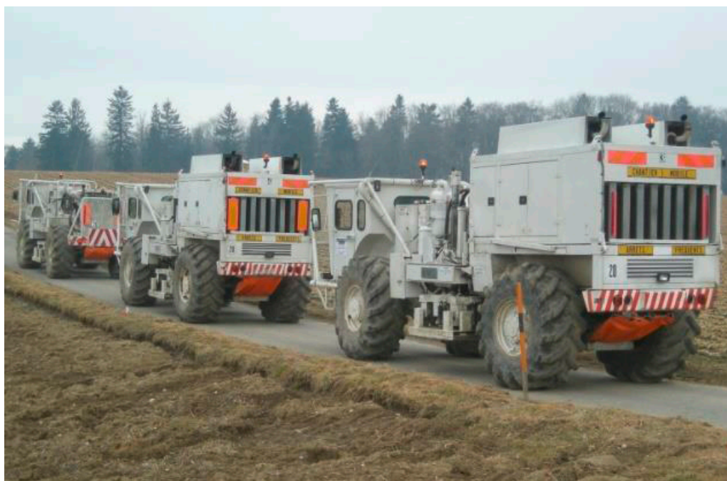
Fahrzeuge für reflexionsseismische Messungen. Quelle: SwissTerraPower
